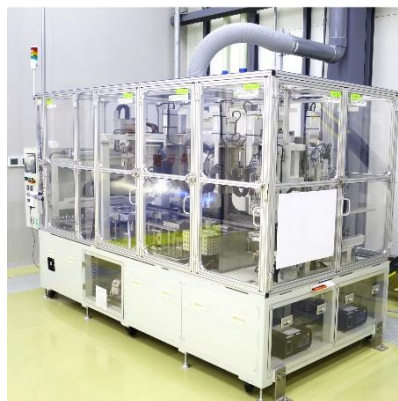
Pletteringsmaskin med automatisk skyving for kontinuerlig flyt
