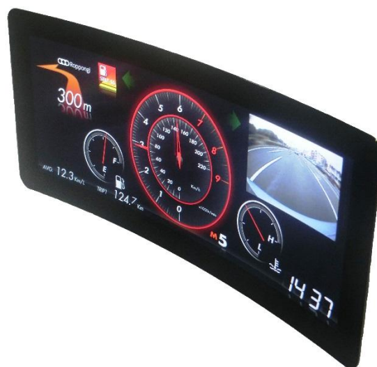
Bueformet TFT-LCD-fargemodul med nyutviklet teknologi (800 mm krumningsradius)
