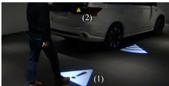
Tre typer (1, 2 og 3) animerte lysmarkeringer endrer seg når sensorene oppdager fotgjengere i nærheten.
