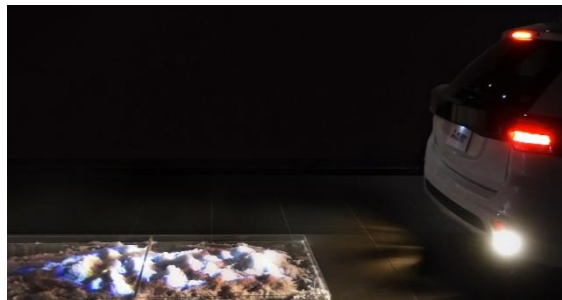
Animerte lysmarkeringer projisert på veioverflater er svært synlige selv i dårlig vær.
