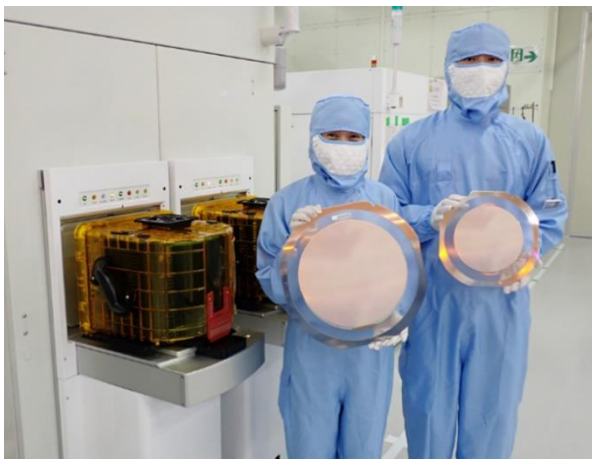
12-tommers silisiumskive og motstandsmålingsutstyr, vist for referanse ved siden av en 8-tommers skive (høyre)
