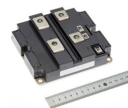
140 x 130 mm isolasjonsspenning 6 kV rms (HVIGBT/HVDIODE*)
