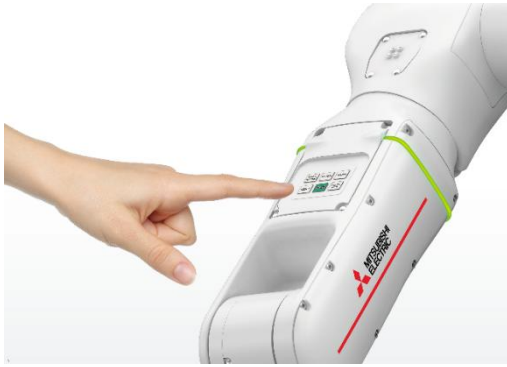
Et eget kontrollpanel på robotarmen gjør det enkelt å lære og registrere robotbevegelser
