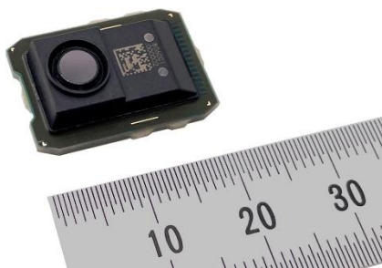
MelDIR 80×60-pikslers infrarød termodiodesensor (MIR8060C1) med 100°×73° synsfelt
