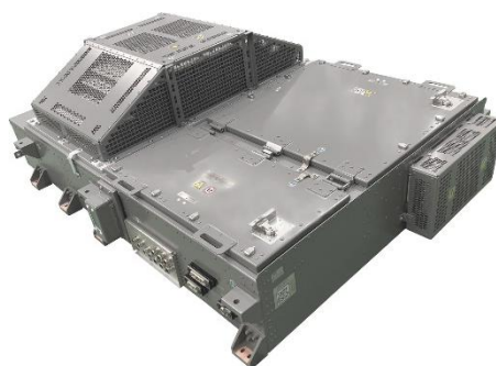
Fremdriftssystemets takmonterte omformer og inverter med naturlig luftkjølingssystem
