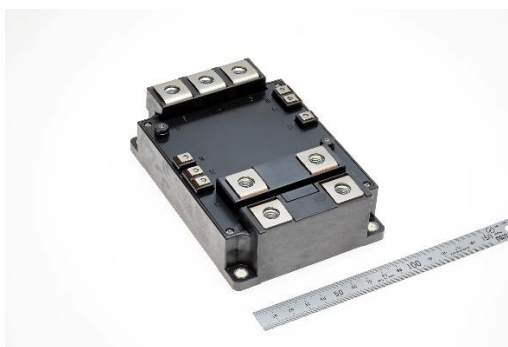
IGBT-modul av LV100-typen i T-serien for industribruk
