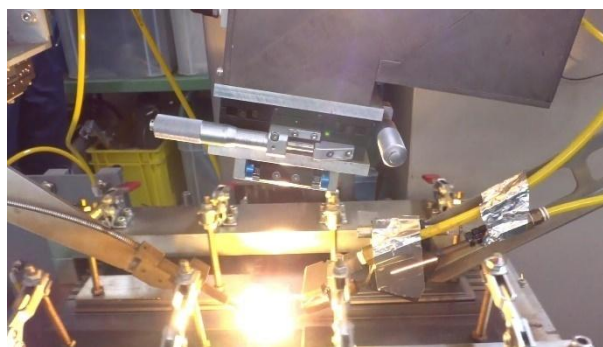
Fig. 1. Visuell sammenligning av sprut under fiberlasersveising
